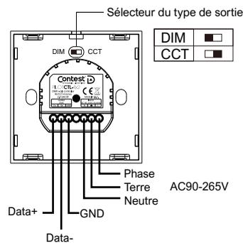
Conseils : Lorsque le panneau doit émettre des signaux DMX512, le type de sortie doit être défini en fonction des produits à contrôler.
